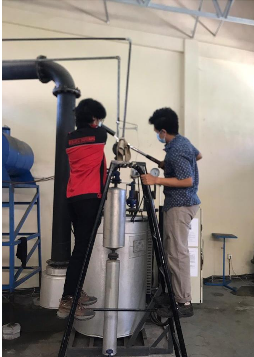
Gambar 3.55. Pengukuran gaya pengetatan pada baut
