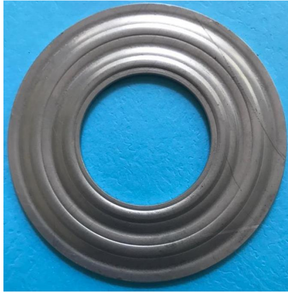
Gambar 5.3. Hasil forming material gasket menggunakan mesin bubut
