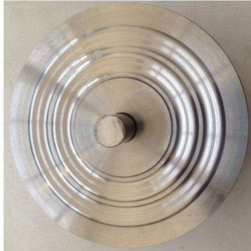
Gambar 3.6. Dies sebelum proses hardening
