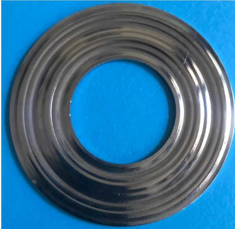
Gambar 5.6. Gasket multilayer yang tergores
