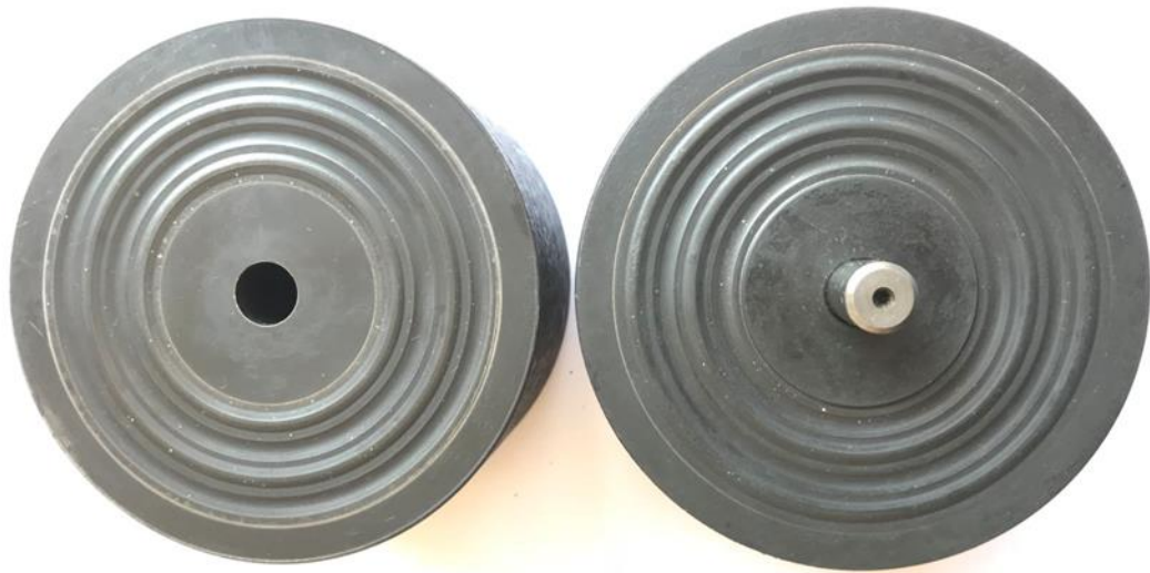
Gambar 3.10. Dies untuk membentuk gasket
