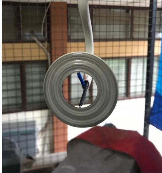
Gambar 3.52. Gasket setelah proses elektroplating nikel
