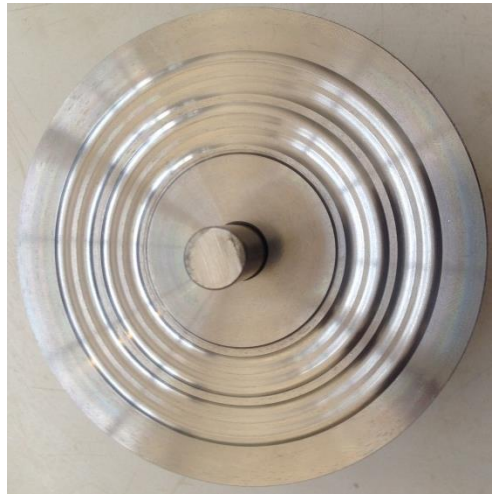
Gambar 3.16. Dies sebelum proses hardening
