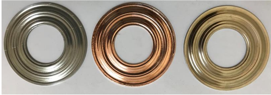
Gambar 3.40. Gasket sebelum coating , coating tembaga dan coating nikel
