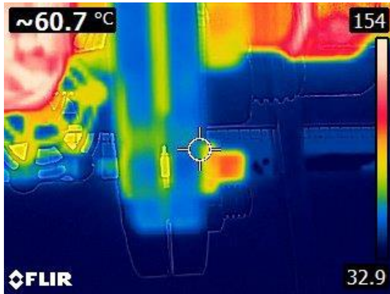
Gambar 3.60. Penunjukan thermal camera yang tidak terjadi kebocoran
