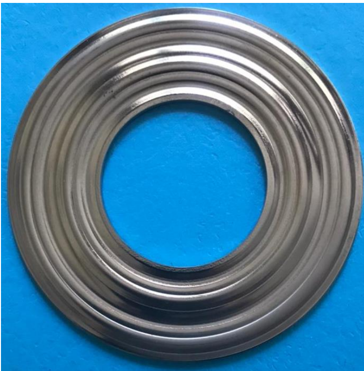
Gambar 5.6. Gasket multilayer yang tidak tergores
