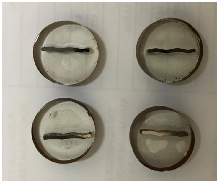
Gambar 3.41. Spesimen uji struktur mikro
